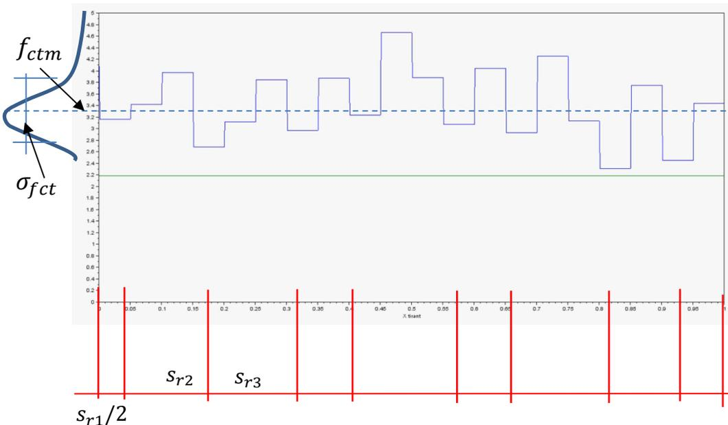
La force de traction appliquée au tirant est augmentée jusqu'à obtenir la fissuration stabilisée (algorithme similaire à Beeby, Scott, 2004)
